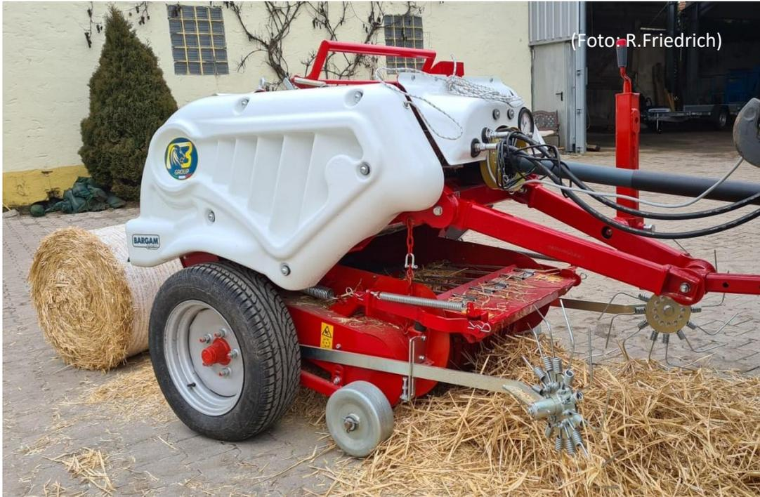
**5. Seilschüttler der Fa. Harter zum Anbau die Heckhydraulik des Traktors**
